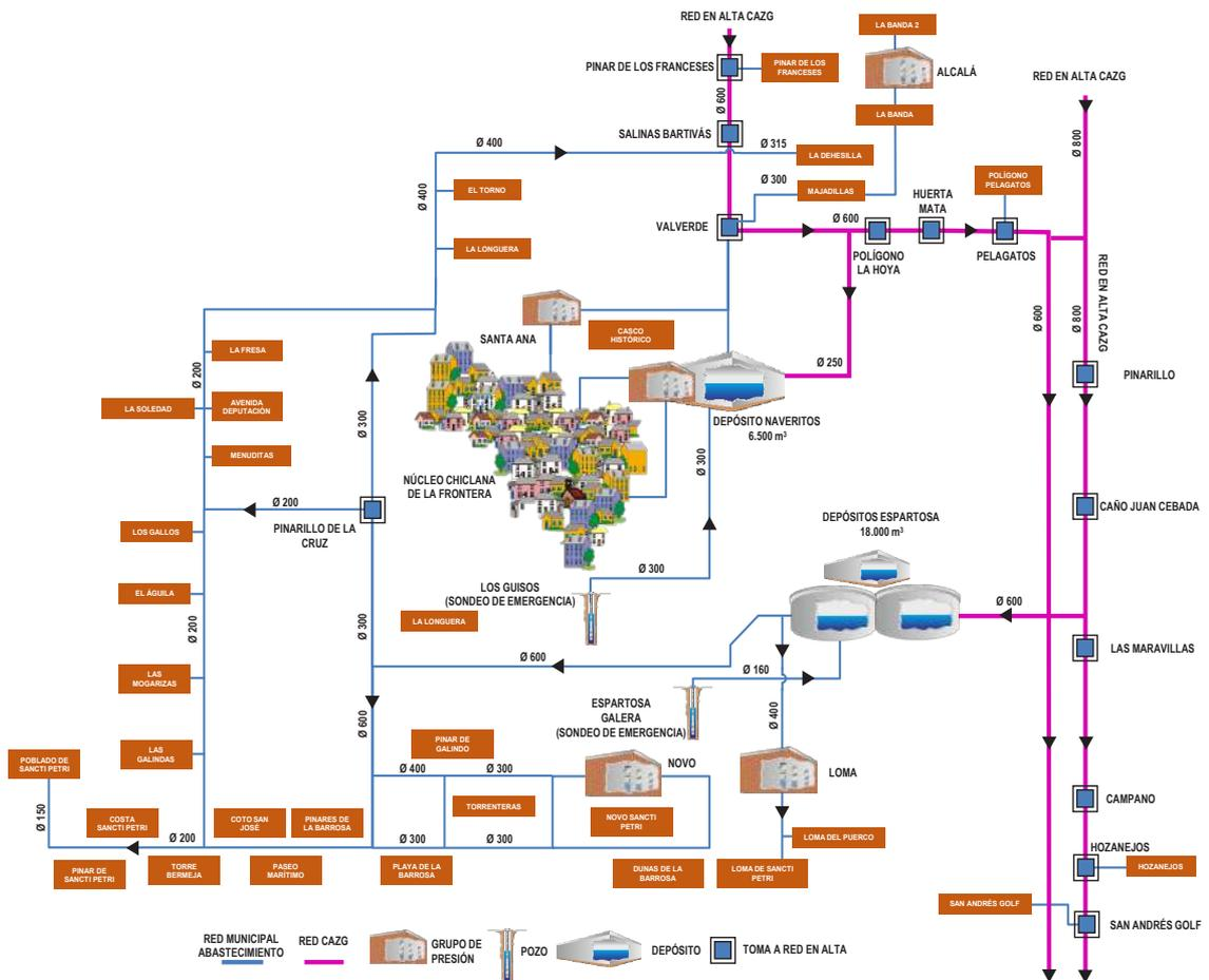
Figura 33. Distribución general de la red de abastecimiento, incluyendo los equipamientos de depósito y grupos de presión en los que se soporta.
